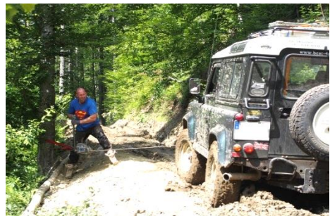
Abbildung 28 Bergung mit Greifzug
