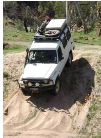
Abbildung 61: Steilabfahrt in Falllinie
