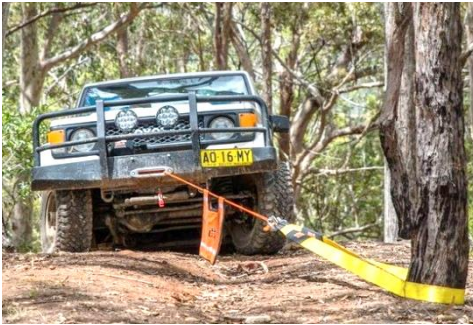
Abbildung 29: Windenbergung mit Baumgurt
