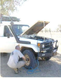
Abbildung 59: Anpassen des Reifendrucks
