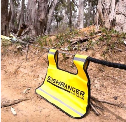
Abbildung 35: Seildämpfer im Einsatz Quelle: www.bushranger.com.au
