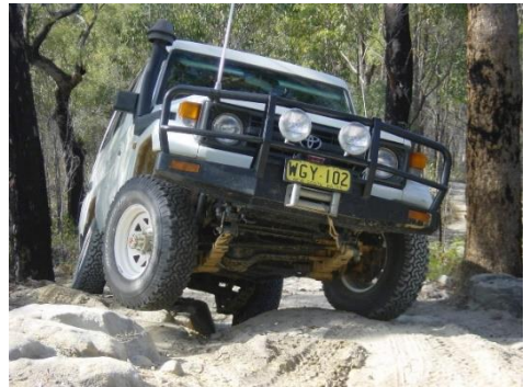
Abbildung 14: Starrachse mit Blattsfedern, verschränkt
