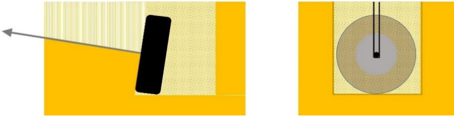
Abbildung 79: Erdanker im Sand durch ein Rad
