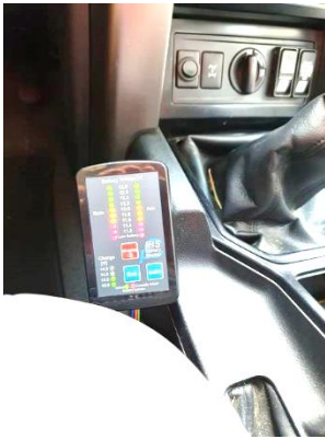
Abbildung 42 Anzeigemodul des IBS Batteriemanager (Quelle: http://ibs-tech.ch/produkte/doppel-batterie-system.html )
