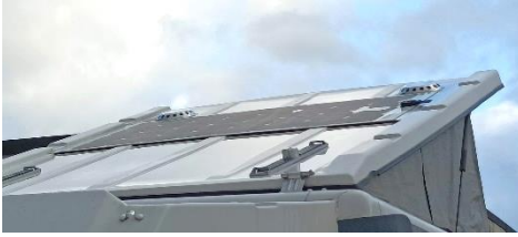
Abbildung 40 Flexibles Solarpanel mit Hinterlüftung montiert ( underway.ch )
