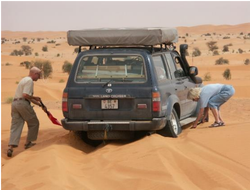
Abbildung 59 Sandblech und Schaufel im Einsatz (underway.ch)
