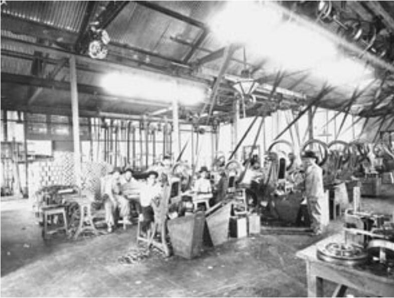
Abb. 4: Produktion kleiner Blechdosen für Corned Beef und Rinderzungen
